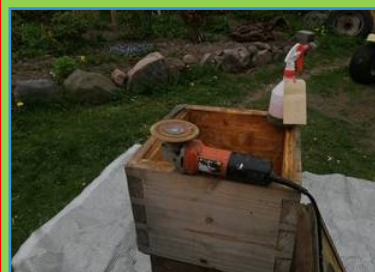
Slib evt. træ-magasinerne med en vinkelsliber med en smergellærred-skive på en gummiskive. Så bliver de som nye.
