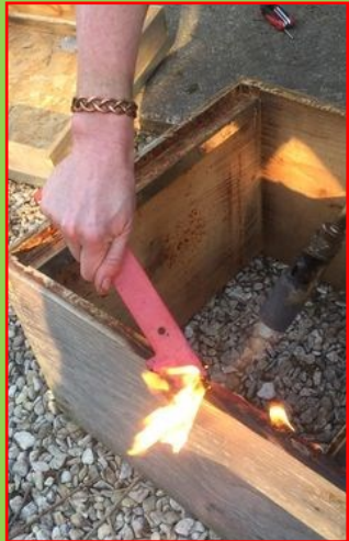
Har du træ-magasiner, så stil dem fx på en jernplade. Så slår varmen tilbage fra gasbrænderen. Magasinerne skal kun opvarmes til træets årer lige nøjagtigt rejser sig.
